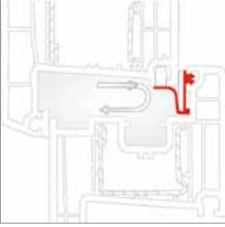
Air Comfort, rüzgar basıncı artınca Bernoulli prensibiyle otomatik olarak kapanır
